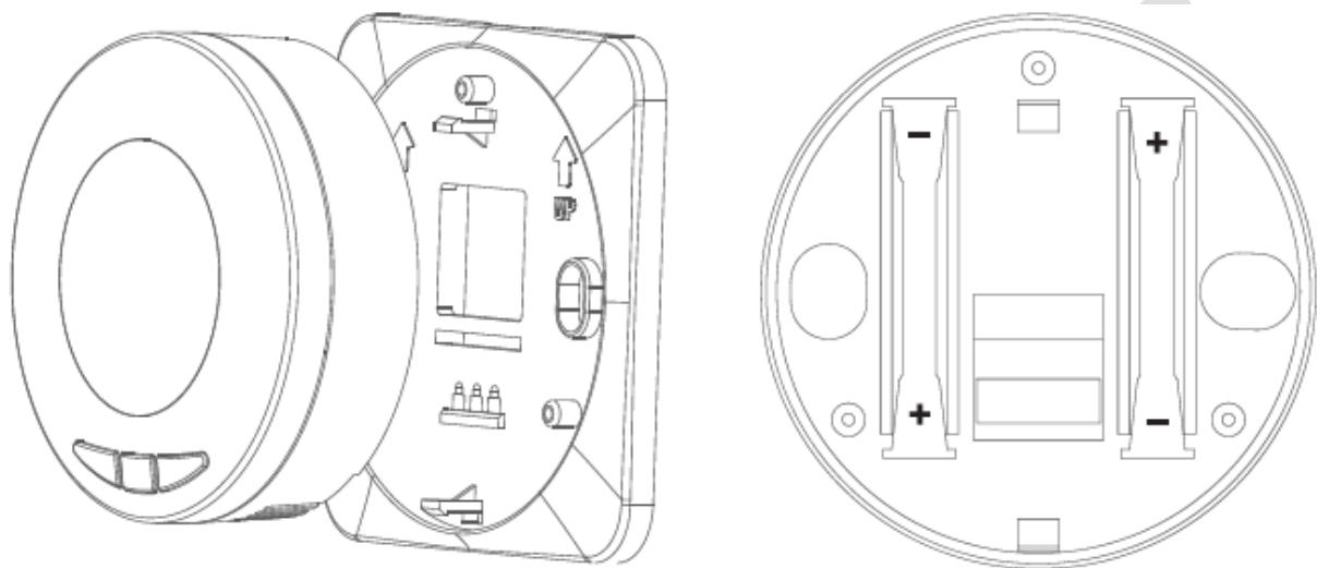
Ubacite 2 alkalne baterije AAA (tip LR03) u okvir proizvoda u držače prema označenim polaritetima.
