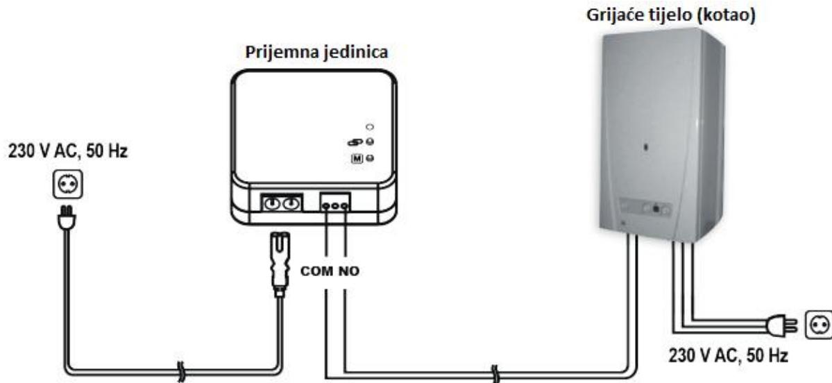
Ako želite upravljati starim bojlerom или другим уређајем (нпр. помпом) који nije спојен на собни термостат, спojite NO i COM прикључне точке пријемника као прикључке на мrežni прикљуčак уређаја који се контролира на sljedeći način.
