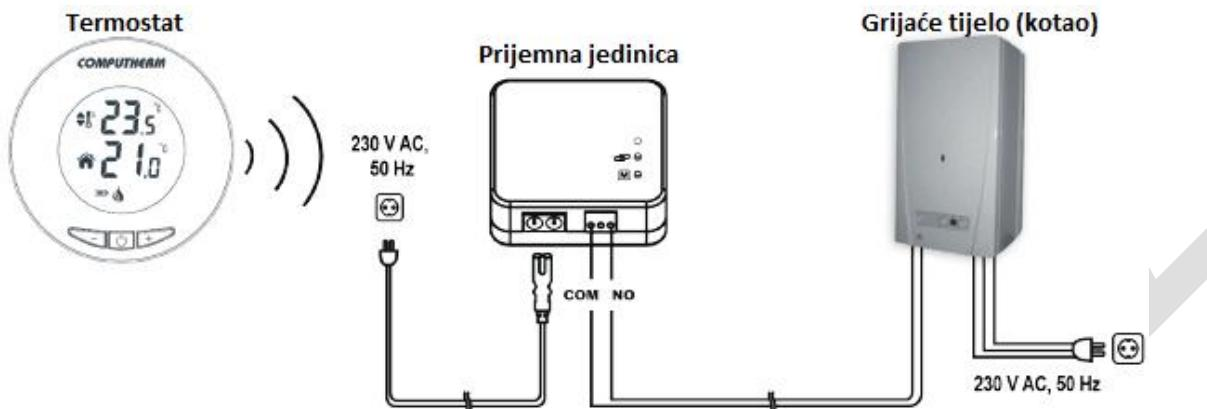
Raspon termostatskog odašiljača na otvorenom je oko 100 m. Ta se udaljenost može značajno smanjiti unutar zgrade, posebno ako metalna konstrukcija, armirani beton ili zid od stope na putu radio valova.
