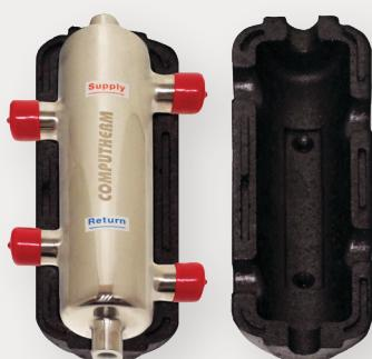
Hidraulička skretnica je uređaj koji se može koristiti za osiguranje neovisnog rada različitih krugova grijanja/hlađenja stvaranjem kratkog spoja između dovodnog i povratnog cjevovoda. Na taj način odvaja opremu za proizvodnju topline od krugova koji troše energiju.
