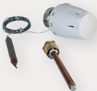
Sonda termostatske glave s kapilarom montirana na regulacijski ventil detektira temperaturu medija koji стоји или тече у чврсном воду помоћу уронске кошулјице и отвара вентил када је температура медија нижа од температуре постављене на скали ступњева, те затвара вентил изнад њега.
