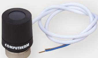
**COMPUTHERM DF-230** je regulator ventila s regulacijom u 2 točke i elektrotermalnim radom. Osigurava njegovo otvaranje/zatvaranje kada se montira na radijatorski ventil ili razdjelnik grijanja pomoću holender spojnica. Otvoreno ili zatvoreno stanje ventila naznačeno je aksijalnim pomicanjem i položajem plavog indikatora statusa na prednjoj strani aktuatora.
