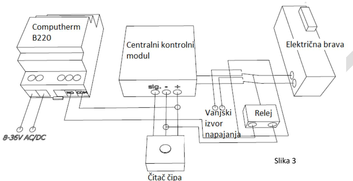
Na slici 3 prikazana je veza, koju daljinski upravljač COMPUTHERM B220 Wi-Fi upravlja sa vanjskim relejem, čije napajanje ide putem središnje jedinice. Kod prebacivanja daljinski upravljač COMPUTHERM B220 prebacuje se i relay ugrađen u upravljač šalje signal električnoj bravi.
